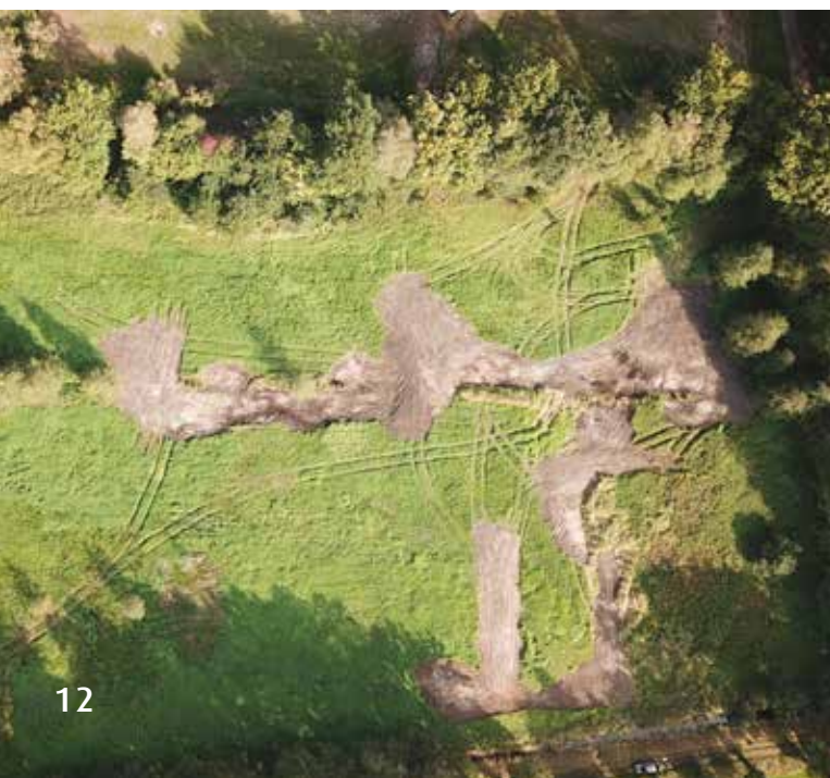
Luftbild der Fläche am Jürsenbach nach Schließung der Entwässerungsgräben und der Anlage von Senken
