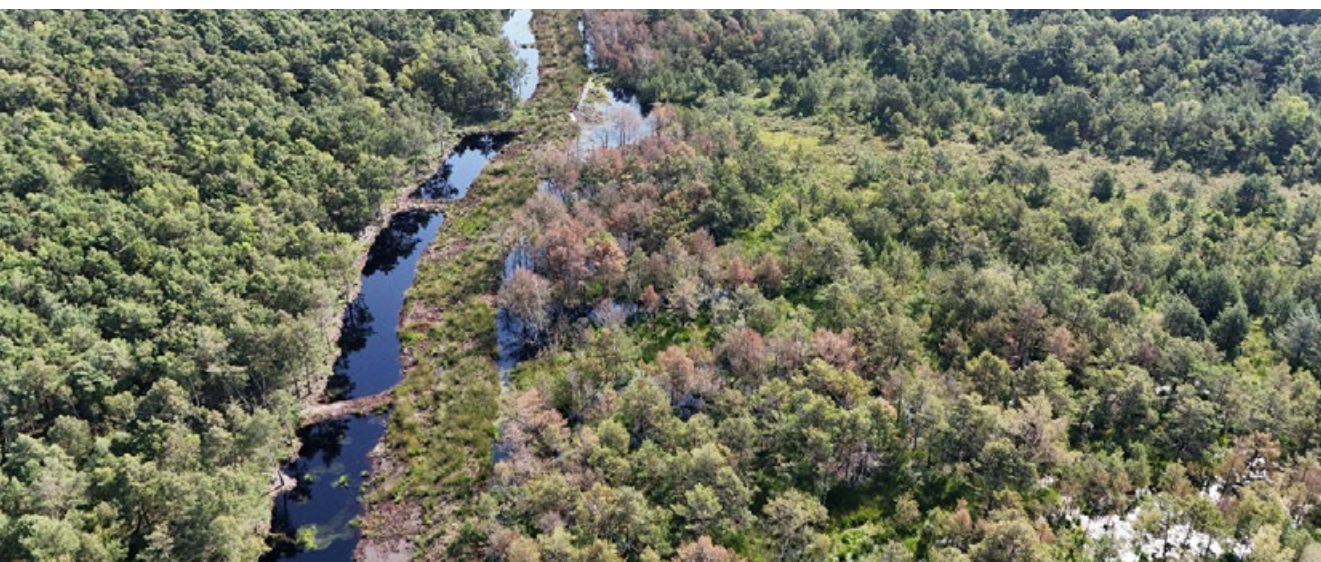
Abb 4: Der Damm im Otternhagener Moor aus Abb. 3 in 2024. Die Maßnahme zur Wiedervernässung zeigt Erfolge: Rechts des Damms ist ein deutlicher Anstau des Wassers zu sehen, in dessen Folge bereits erste Bäume absterben.
