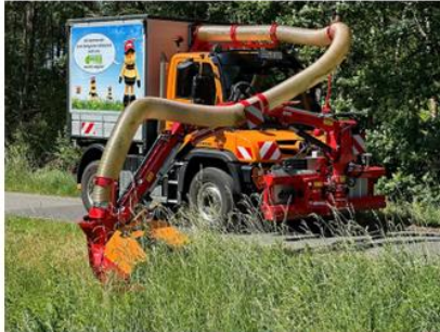
Der neue Ökumäher SG 1200 von Dücker ist in der Lage, Stroh und Mulch zu verarbeiten.
