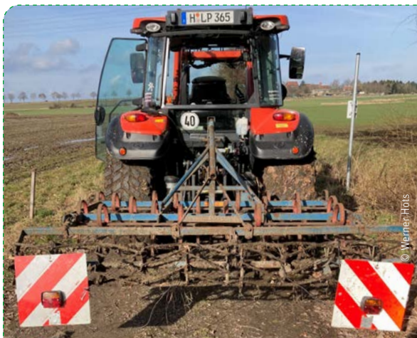
Der Traktor mit angebautem Grubber zur Lockerung des Bodens
