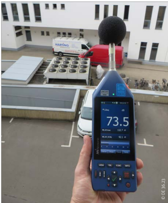
Beispielhafte Geräuschmessung an einer gewerblichen Anlage
