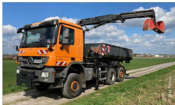
Der Abrollkipper mit Allradfunktion (6x4)
