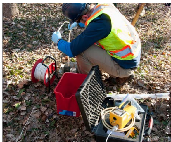
Grundwasseruntersuchung im Rahmen einer Orientierenden Untersuchung
