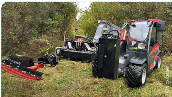
Teleskoplader mit Astschere
