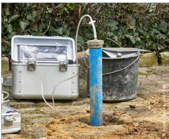
Bodenluftuntersuchungen im Rahmen einer Orientierenden Untersuchung
