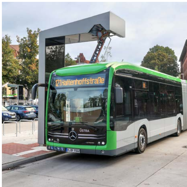
Abb. 56 Lademast Pantograph für Elektrobusse
