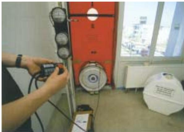
Test de perméabilité à l'air
