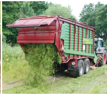
Heumulchübertragung in einer Flutmulde der Auter bei Basse
