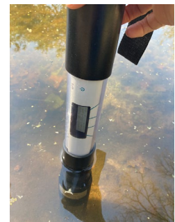
ABBILDUNG 4: CHLOROPHYLLMENGE MIT SONDE ALGAE TORCH MESSEN
